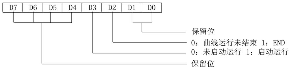
DH附表：仪表可读写参数（仪表型号不同时，对非该表使用的参数进行读写无意义。）
